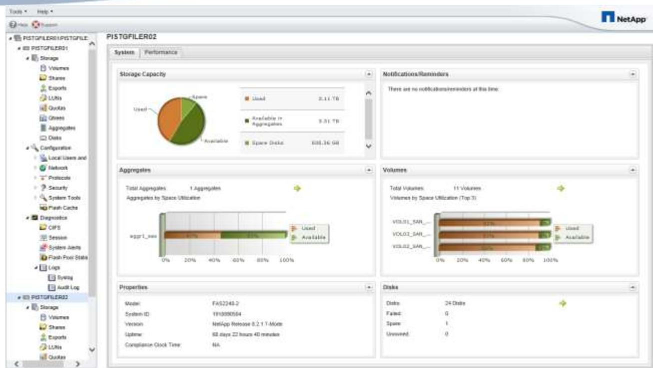
O sistema de armazenamento de dados NetApp FAS2240-2 é composto por duas controladoras (PISTGFILER01 e PISTGFILER02), configuradas em modo ativo-ativo.
